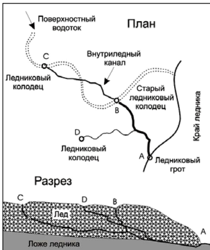
Рис. 4.12. Схема развития типичной разветвленной системы ВДС последовательным перехватом поглощаемых поверхностных потоков при питании через ледниковые колодцы. Сегмент В-А формируется сначала из-за короткого пути течения воды и большого градиента. Сегмент С-В присоединяется позже, ему помогает растущий градиент, поскольку сегмент В-А развивается. (С-В не обязательно присоединяется к В-А в точке В). Канал от колодца D образуется последним из-за ограниченных размеров области водосбора. Пунктиром на плане показан перехваченный колодцами поверхностный водоток.
