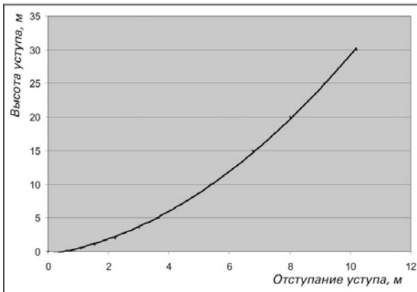
Рис. 4.21. Зависимость отступления уступа колодца от его высоты; колодец 1, ледник Альдегонда (Шпицберген).
