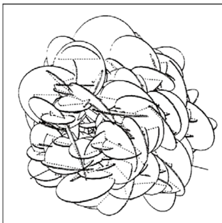
Рис. 3.10. Модель, иллюстрирующая систему пересекающихся трещин в горной породе [460].
